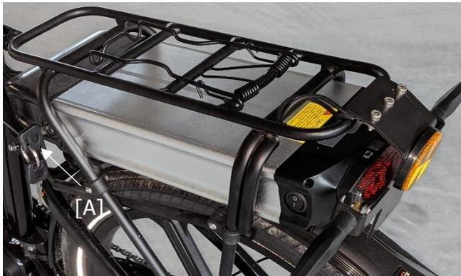
Klappen Sie den Mechanismus, wo die Blinker und die Nummernhalterung angebracht sind nach oben und ziehen Sie den Akku nach hinten heraus
