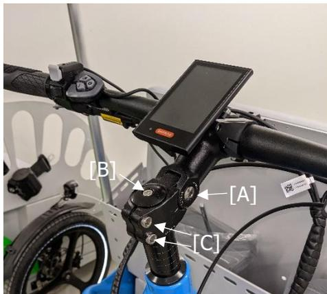
Die Lenkneigung hat Einfluss auf den Abstand des Lenkers zum Oberkörper. Finden Sie selbst heraus, welches für Sie die angenehmste Position ist.
